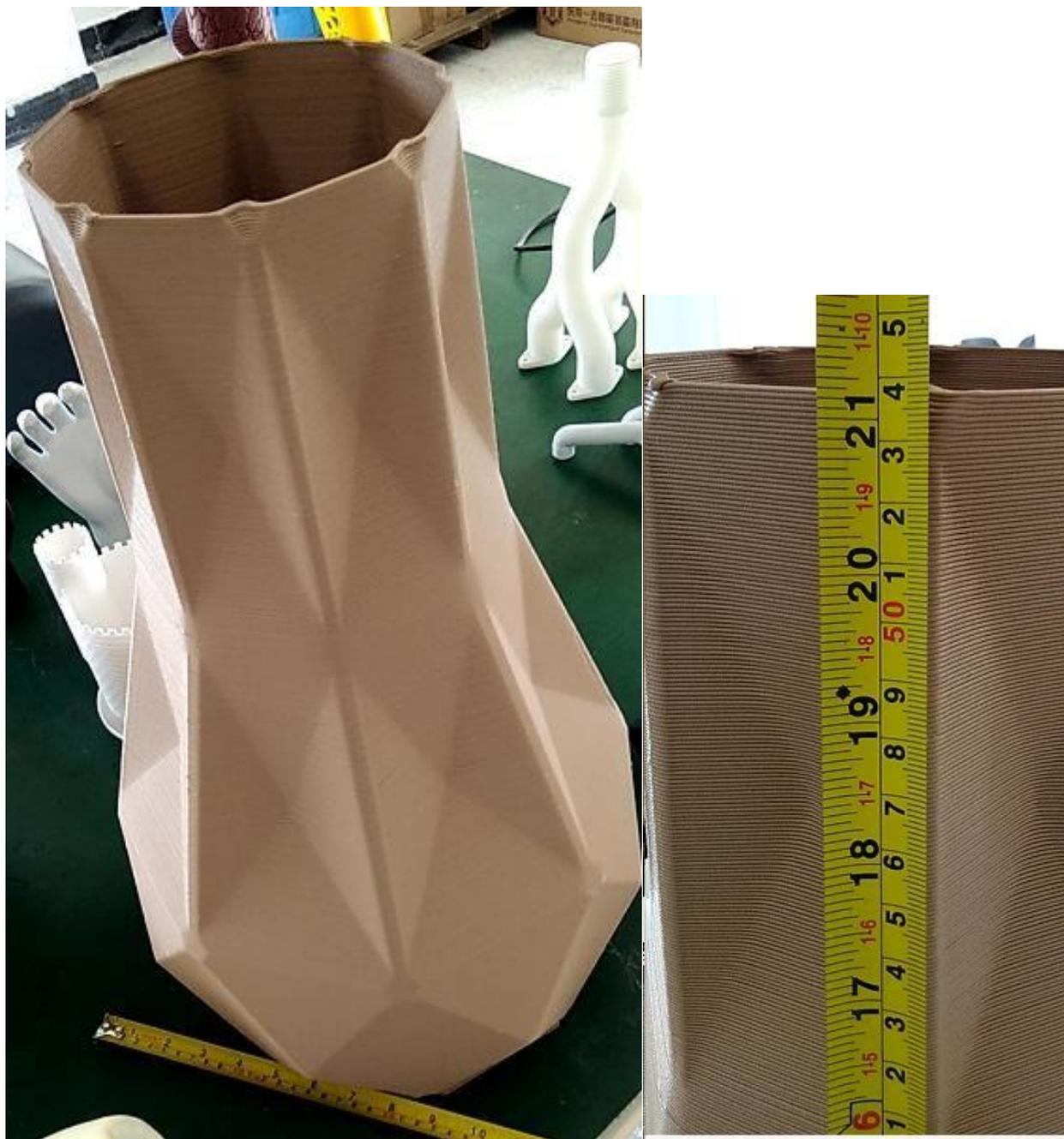
**5. Jarrón de arte, Tamaño: H149 x D50 cm, impreso por impresora 3D de pellets, pellet PETG, 19 horas. Diámetro de pico 2,0 mm, altura de capa 1,2 mm, espesor de pared de 5 mm.**
